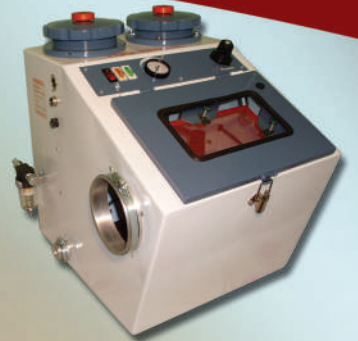
سند بلاست یک قلو سه کاره (افقی - Horizontal) - گرم کبالت - پرسیلن - اکسید آلومینیوم (قلمی) - سیستم ۱۲ ولت و کنترل با پدال
