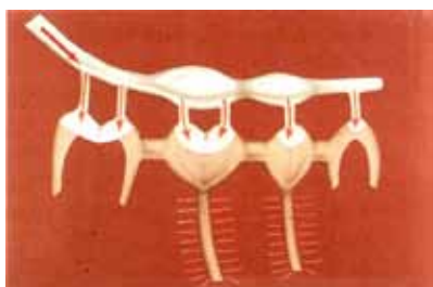
شکل ۲ - قراردادن chill vent (مسیرهای خروجی خنک کننده) اضافی و زیاد کردن ضخامت کاننور بینابین اسپرو و پونتیگ
